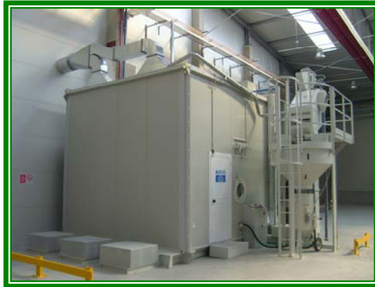
CONIEX CAMARA DE GRANALLADO
